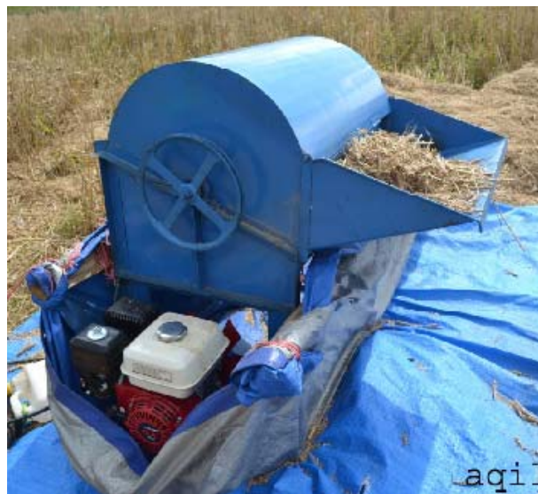
Gambar 1. Prototipe mesin perontok gandum rancangan Balitsereal.
