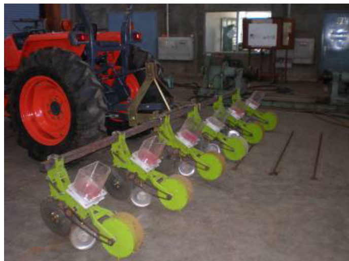
Gambar 8. Alat pemupukan dan tanam dengan tenaga penggerak traktor roda empat (prototipe 2) rekayasa BB Mektan.
